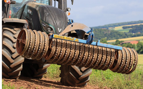
Die Cambridge-Walze sorgt für eine angemessene Rückverfestigung des gemulchten Bodens und somit für günstige Keimbedingungen.
